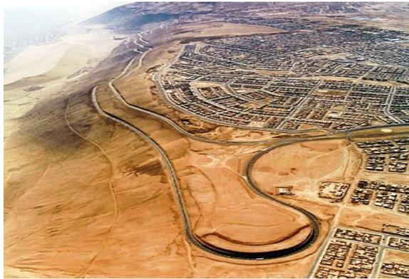
A partir del Km. 3,6 la calzada de subida se separa de la existente hasta empalmar en Alto Hospicio. El resultado es un nuevo eje con dos pistas de subida de menor gradiente, a objeto de facilitar el transporte de carga y disminuir la accidentabilidad en la vía, además de áreas de miradores para la ciudad.
