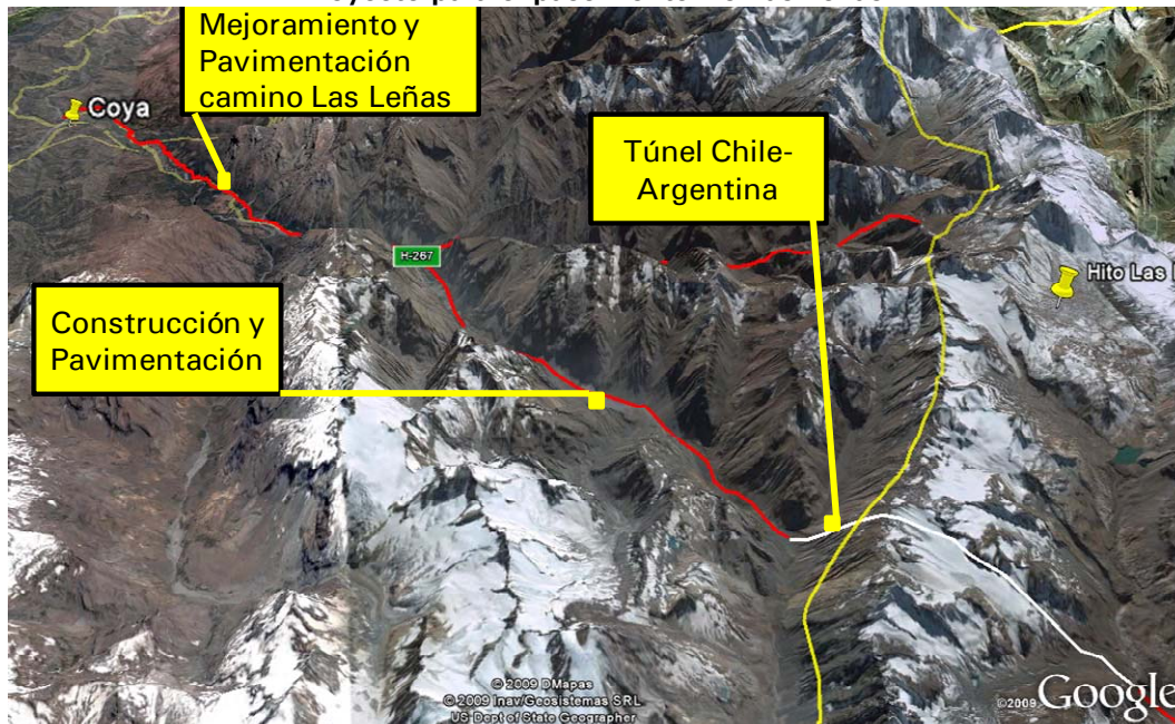
Figura 2-1 Proyecto para el paso fronterizo Las Leñas.
